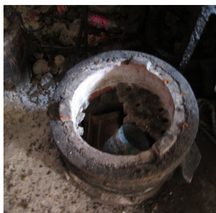
Sur la gauche, une fissure sur la paroi en céramique de la chambre de combustion. Au centre, une grille de la chambre de combustion cassée. Sur la droite, un déplacement entre l'entrée en céramique et l'étanchéité.
