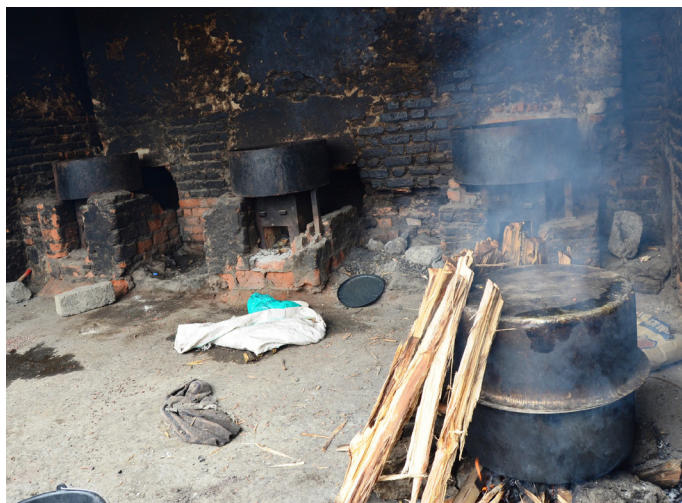
À l'arrière, des réchauds améliorés construits par Mercy Corps dans la prison de Muzenze en 2011. À l'avant, un réchaud traditionnel en cours d'usage. © Alvaro Trincado
