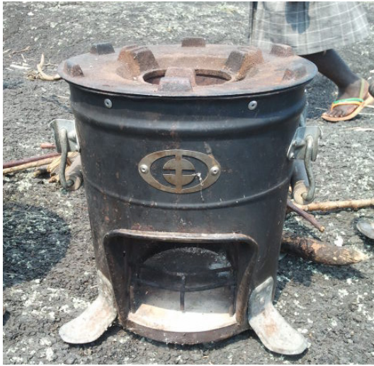
Le réchaud à bois éconergétique Envirofit M-5000 après 10 mois d'utilisation dans le camp de Nzulo
