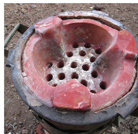
Sur la gauche, une fissure sur la paroi en céramique de la chambre de combustion. Au centre, une grille de la chambre de combustion cassée. Sur la droite, un déplacement entre l'entrée en céramique et l'étanchéité.
